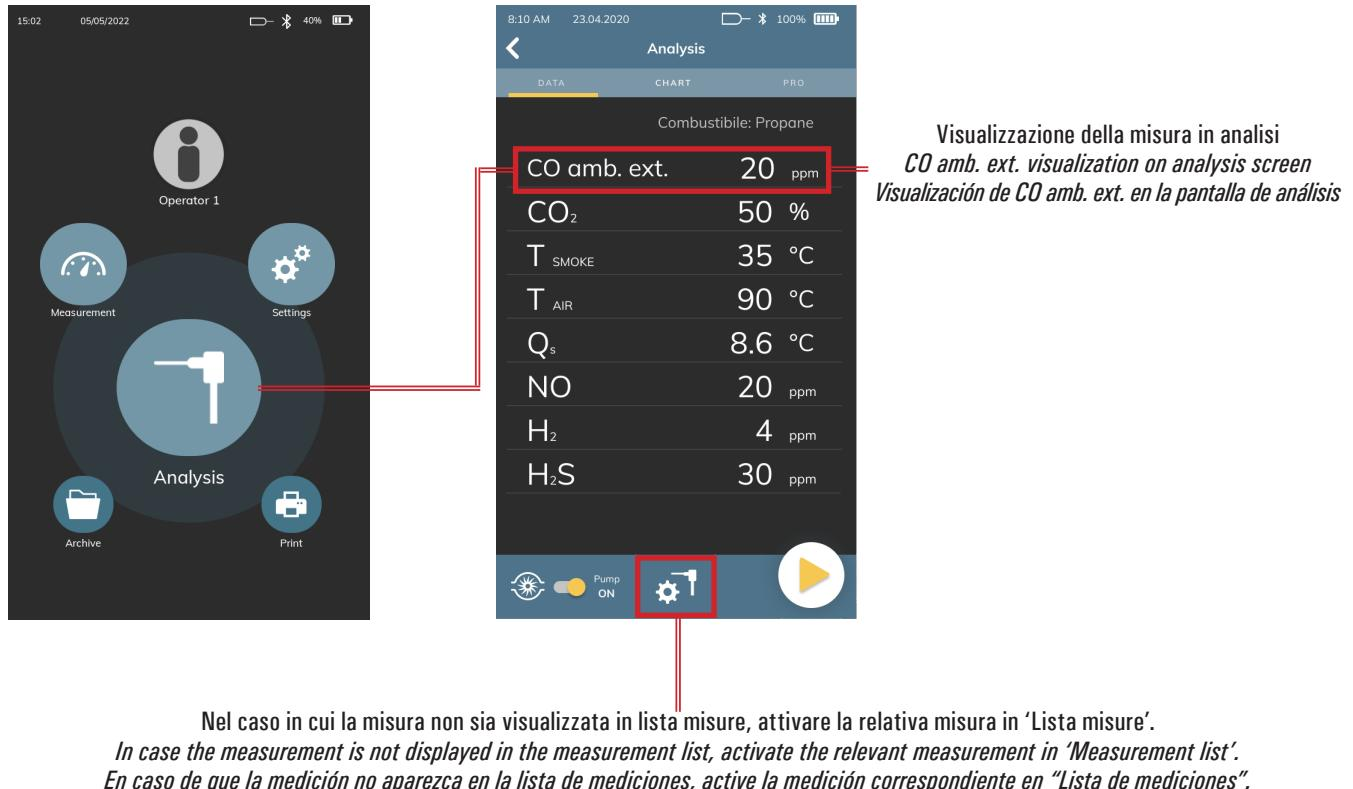
Nel caso in cui la misura non sia visualizzata in lista misure, attivare la relativa misura in 'Lista misure'.
