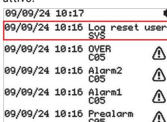
Quindi premere il pulsante **ESC** (esc) per uscire dalla schermata di log e tornare alla schermata principale (ovvero quella che mostra i riquadri di stato dei trasmettitori con le misure di concentrazione). Il trasmettitore che ha generato l'evento di Overrange viene identificato con le scritte **PRE AL1 AL2** nell'angolo in basso a sinistra e al posto della misura compare la scritta **OVER** lampeggiante.
