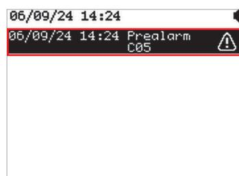
Su ciascuna riga viene visualizzata la data e l'ora in cui si è verificato l'evento ed il tipo di evento anomalo (in questo caso Stato di Preallarme del trasmettitore C05).
