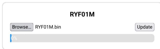
11. Quando la barra di stato ha raggiunto il 100% è stato completato l'aggiornamento del firmware.
