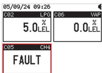
**Se vengono meno le condizioni che hanno causato l'attivazione dello stato di Fault**, la centralina spegne il led arancione FAULT e disattiverà o meno i relè ed il buzzer a seconda di come è stato configurato il parametro "Latch" presente nel menu "Relays" e "Buzzer" per lo stato di Fault e visualizzerà o meno le informazioni sulla cessazione dello stato di Fault a seconda dell'impostazione del parametro "Info event" presente nel menu "System =>Log".
