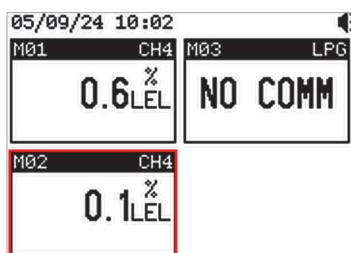
**Se la comunicazione tra il trasmettitore e la centralina viene ripristinata**, la centralina spegne il led arancione FAULT e disattiverà o meno i relè ed il buzzer a seconda di come è stato configurato il parametro "Latch" presente nel menu "Relays" e "Buzzer" per lo stato di Fault e visualizzerà o meno le informazioni sulla cessazione dello stato di NO COMM a seconda dell'impostazione del parametro "Info event" presente nel menu "System =>Log".
