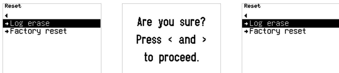
**Factory reset:** Tramite questo parametro la centralina viene ripristinata ai valori di fabbrica.
