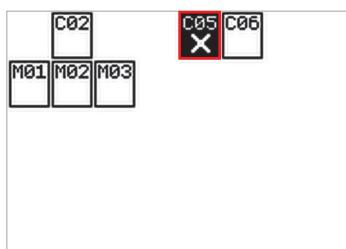
Il trasmettitore che ha rilevato una condizione anomala viene identificato con una X su sfondo nero lampeggiante: **C05**, mentre gli altri mostrano solo l'identificativo numerico del sensore. Nell'esempio seguente, il sistema ha 6 trasmettitori connessi, di cui il C05 ha generato l'evento (in questo caso segnala il superamento della soglia preallarme).
