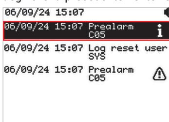
Su ciascuna riga viene visualizzata la data e l'ora in cui è cessato l'evento ed il tipo di evento anomalo (in questo caso Stato di Preallarme del trasmettitore C05).
