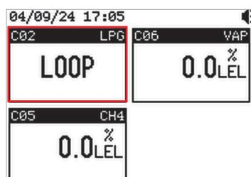
**Se la comunicazione tra il trasmettitore e la centralina viene ripristinata**, la centralina spegne il led arancione FAULT e disattiverà o meno i relè ed il buzzer a seconda di come è stato configurato il parametro "Latch" presente nel menu "Relays" e "Buzzer" per lo stato di Fault e visualizzerà o meno le informazioni sulla cessazione dello stato di LOOP a seconda dell'impostazione del parametro "Info event" presente nel menu "System =>Log".
