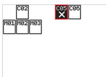
Il trasmettitore che ha rilevato la condizione anomala viene identificato con una X su sfondo nero lampeggiante: **C05 X**, mentre gli altri mostrano solo l'identificativo numerico del sensore.
