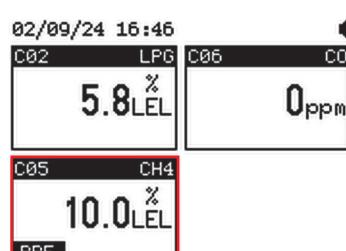
Quindi premere il pulsante **Esc** (esc) per uscire dalla schermata di log e tornare alla schermata principale (ovvero quella che mostra i riquadri di stato dei trasmettitori con le misure di concentrazione). Il trasmettitore che ha generato l'evento di preallarme viene identificato con la scritta **PRE** nell'angolo in basso a sinistra.
