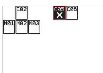
Il trasmettitore che ha rilevato la condizione anomala viene identificato con una X su sfondo nero lampeggiante: **C05 X**, mentre gli altri mostrano solo l'identificativo numerico del sensore.
