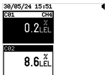
Premendo i pulsanti freccia, si seleziona il riquadro di stato corrispondente a ciascun trasmettitore collegato; per primi vengono visualizzati tutti i trasmettitori collegati agli ingressi 4 .. 20 mA (contraddistinti dal prefisso "C") e poi tutti i trasmettitori collegati sulla rete RS 485 (contraddistinti dal prefisso "M").
