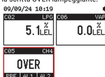
In alternativa, dalla schermata panoramica degli eventi, premendo per 3 secondi il pulsante di reset esterno (eRST), la centralina visualizza direttamente la schermata principale **senza passare attraverso la schermata di log**.
