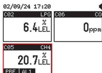
Quindi premere il pulsante **Esc** (esc) per uscire dalla schermata di log e tornare alla schermata principale (ovvero quella che mostra i riquadri di stato dei trasmettitori con le misure di concentrazione). Il trasmettitore che ha generato l'evento di alarm1 viene identificato con la scritta **AL1** nell'angolo in basso a sinistra.
