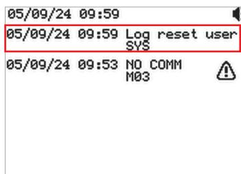
Quindi premere il pulsante
