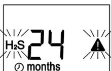
Si **be safe SG** ne réussit pas l'autotest, l'icône d'avertissement "▲" clignote et le capteur se met à clignoter. **be safe SG** doit alors répéter l'autotest.
