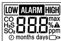
3. Ensuite sur l'écran s'affichent les réglages du seuil bas de l'alarme (LOW ALARM) et du seuil haut (ALARM HIGH). Ces données sont réglables sur le logiciel pour PC "**be safe SG IR-Link manager**" (voir l'annexe A):
