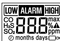
3. Sucesivamente el display muestra los ajustes de alarma baja (LOW ALARM) y alarma alta (ALARM HIGH). Es posible ajustar estos datos mediante el software per PC "**be safe SG IR-Link manager**" (ver el apéndice A):
