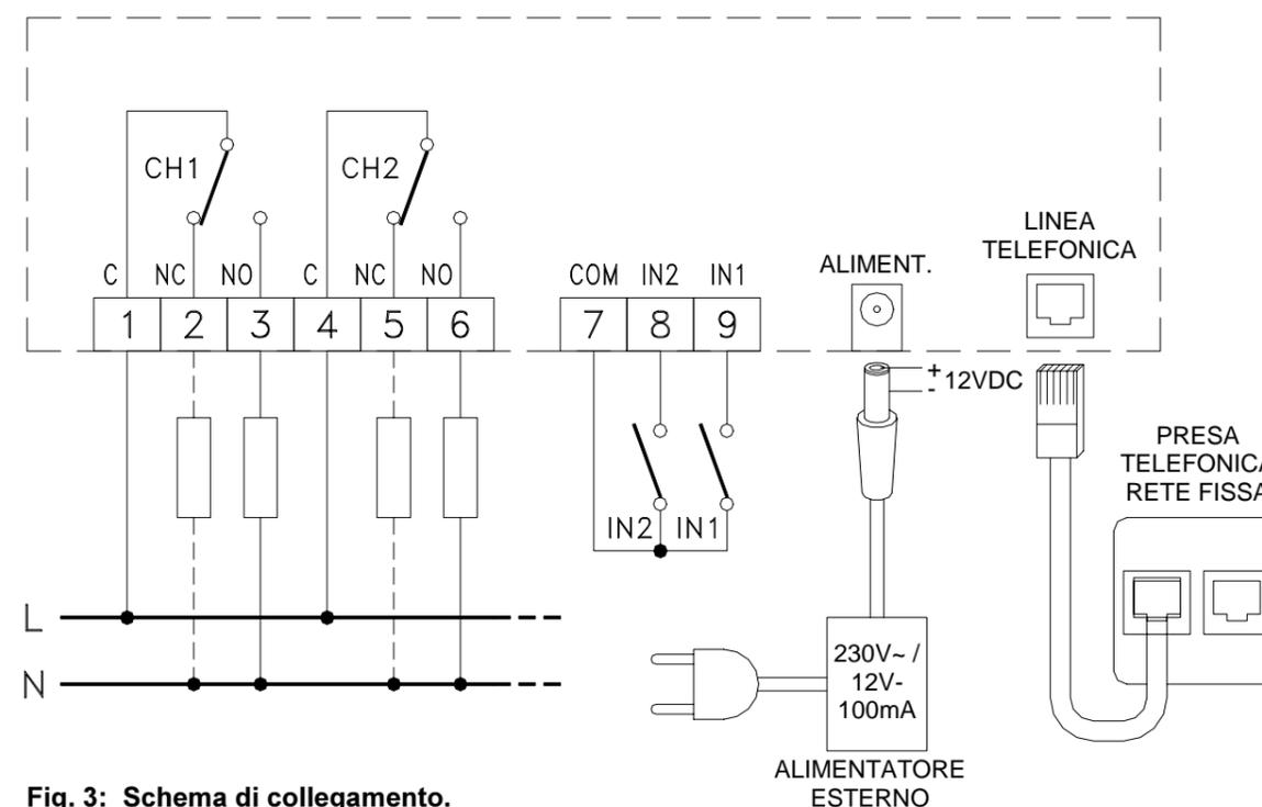
Fig. 3: Schema di collegamento.
