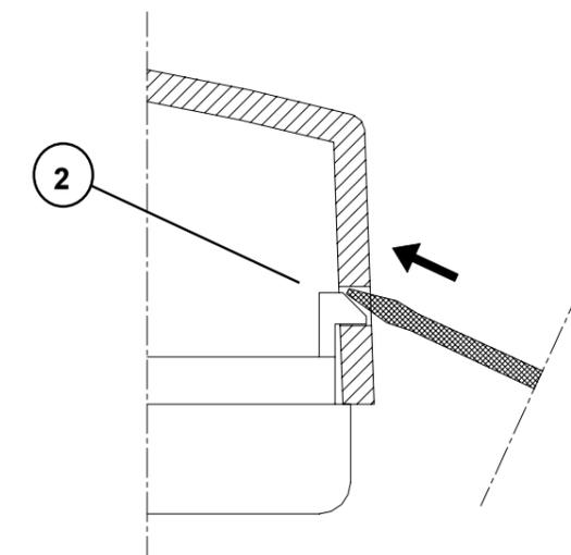
Fig. 2: Rimozione calotta.
