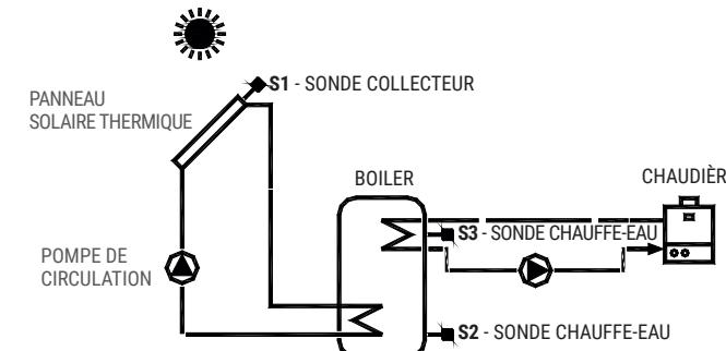
En cas d'installations à 2 panneaux solaires, les sondes correspondantes à S1 et S4 doivent avoir absolument une amplitude de -50 °C .. +200 °C.
