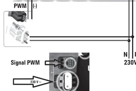
**EXEMPLE DE CONNECTION POUR CIRCUATEURS SOLAIRES À 3 VITESSES AVEC ROTOR NOYÉ OU BIEN "HIGH EFFICIENCY", CONFORMES À LA DIRECTIVE ErP 2015, QUI NE NÉCESSITENT PAS DE SIGNAL PWM EXTERNE (SANS CONNECTEUR POUR PWM).**
