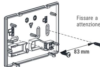
Fissare a muro la base di **freetime evo radio** utilizzando le viti in dotazione, facendo attenzione a fare passare i fili della sonda remota, se presente.
