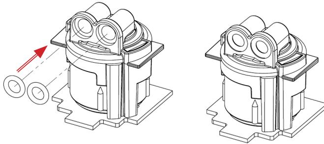
**Le nouveau capteur est fourni complet des deux oring; S'assurer qu'ils soient bien introduits dans l'emplacement prévu pour le capteur (voir l'exemple sur la figure).**
