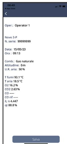
Les données de l'analyse considérée s'affichent. Appuyez sur le bouton "Save" pour enregistrer les données de l'analyse sur l'appareil.
