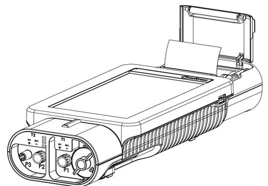
4. Fermer le bloc couvercle de l'imprimante en pratiquant une légère pression sur celui-ci de façon à le fixer à l'instrument.
