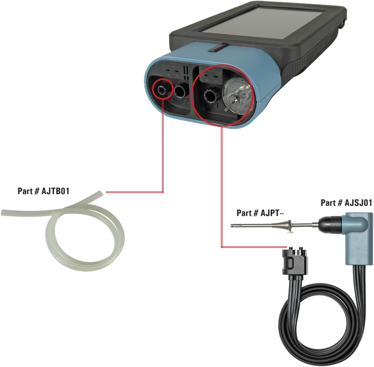
7.3 Connexion du kit de mesure de la pression différentielle à l'instrument
