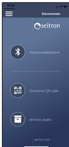
Lorsque l'application démarre, l'écran suivant s'affiche. Appuyez sur le bouton "Scan QR code" et scannez le code QR présenté par l'analyseur.
