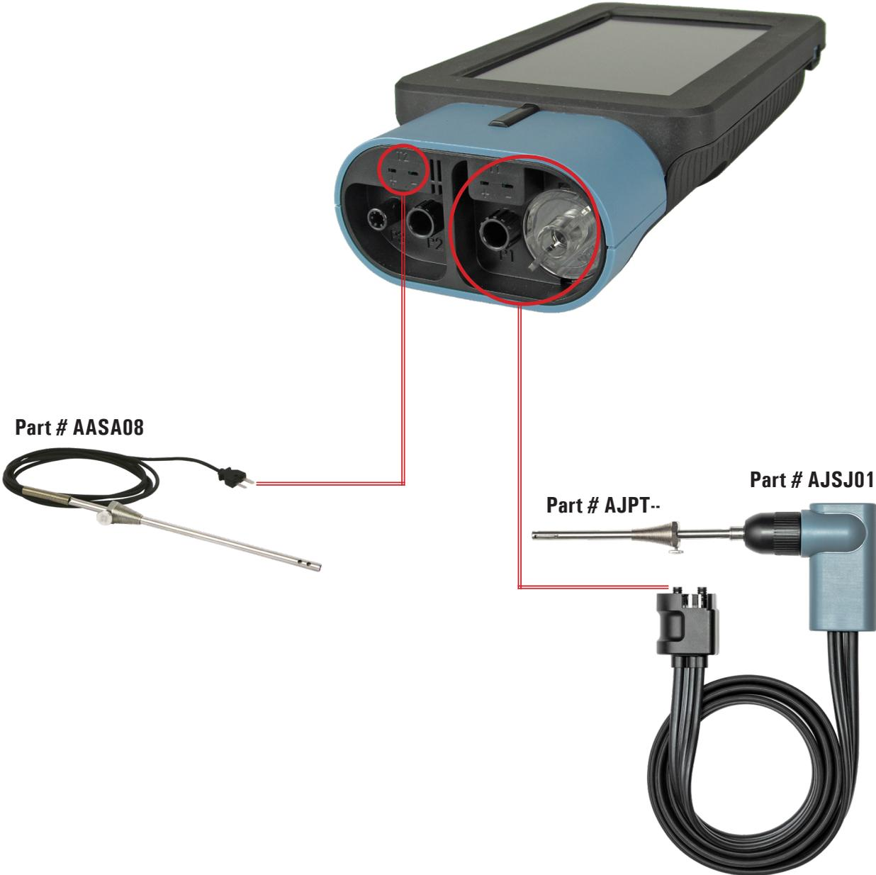
**7.2 Raccordement de la sonde pour la mesure simultanée des pressions, O2, des polluants et le calcul du rendement**
