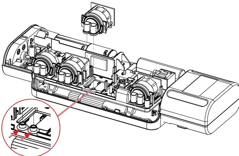
**Quand on enlève le capteur, les deux joints oring de celui-ci pourraient rester en position sur les raccords de l'instrument (voir l'exemple sur la figure); il faut les enlever.**
