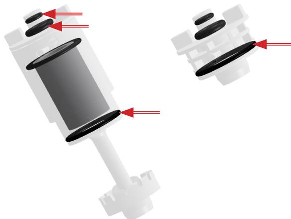
2. Six joints présents sur le connecteur de la sonde de prélèvement de fumée et sur le connecteur de l'extension relative.
