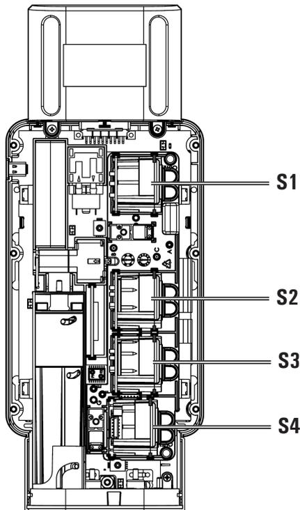
3. Lorsque la position du capteur à remplacer est déterminée, tirer vers le haut le capteur.
