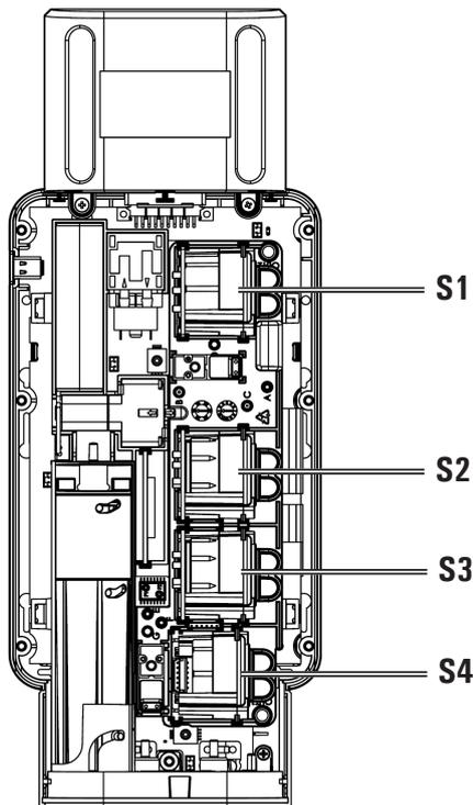
3. Una vez identificado el sensor a sustituir, empujar hacia arriba el sensor (el ejemplo se refiere al sensor en posición 2).
