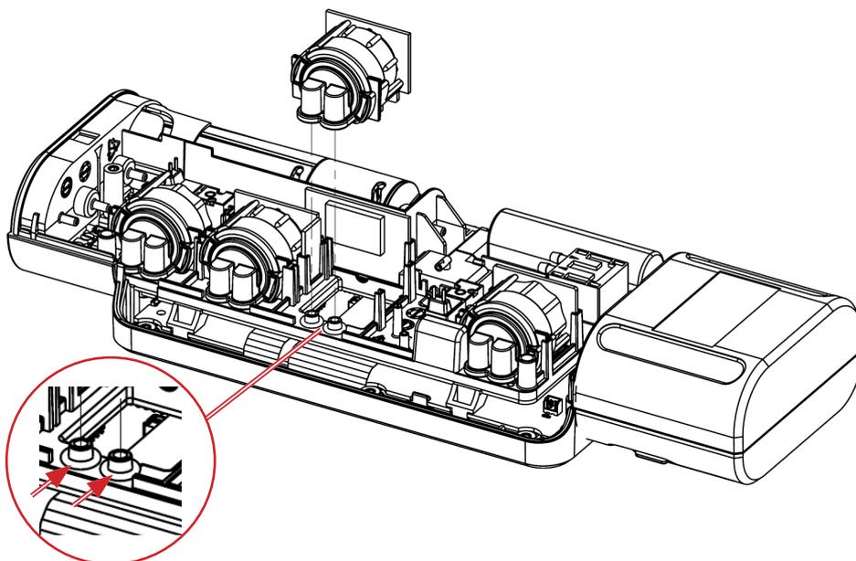
**Al retirar el sensor es posible que las dos juntas tóricas permanezcan dentro del conector del analizador (véase ejemplo); si así fuera, es necesario retirarlas.**
