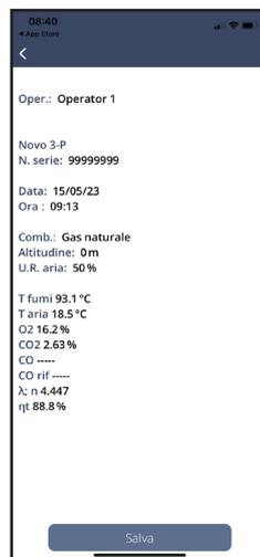
Aparecen los datos del análisis considerado. Pulse el botón "Guardar" para guardar los datos del análisis en el aparato.
