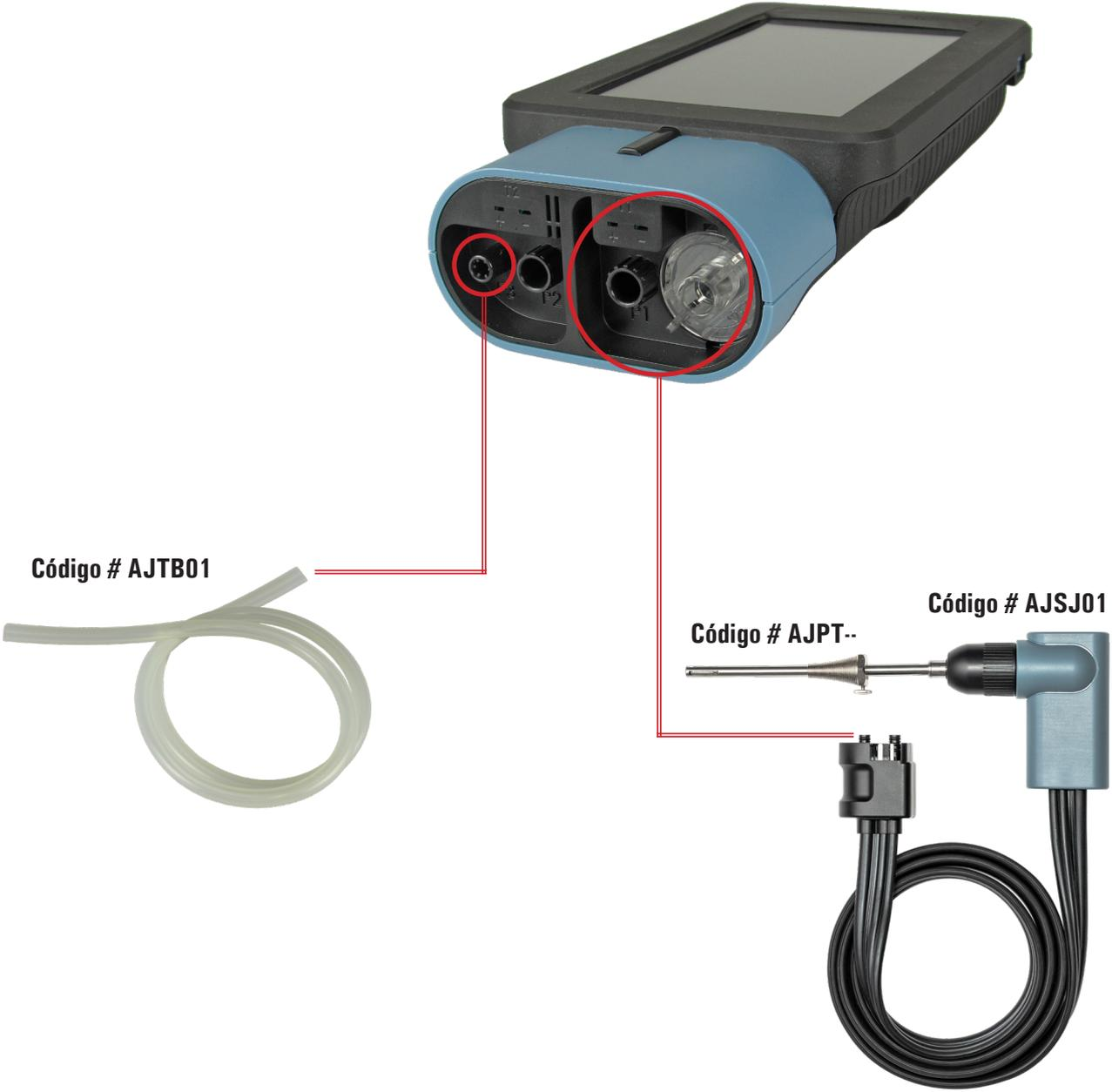
7.3 Conexión del kit para la medición de las presión diferencial
