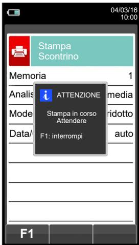
**NOTA:** Se nel configurare l'analisi è stata selezionata la modalità di stampa automatica, la stampa dell'analisi media viene avviata automaticamente.
