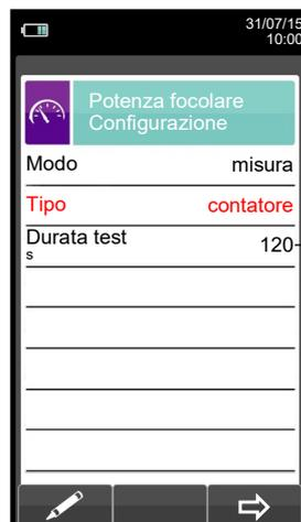
E' possibile scegliere se calcolare la potenza termica immettendo un valore di portata oppure attraverso la lettura del contatore volumetrico (solo per combustibili gassosi).
