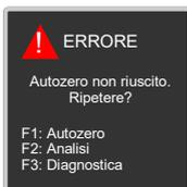
**Questo messaggio di errore verrà visualizzato solo nel caso in cui non venga effettuato l'autozero dello strumento.**
