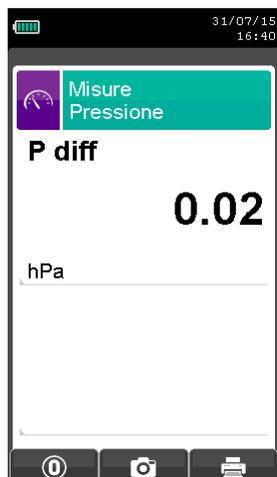
Misura della pressione differenziale mediante l'utilizzo del sensore di pressione interno piezoresistivo, compensato in temperatura.
