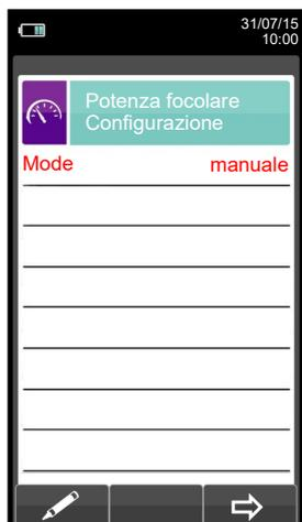
Inserire il valore della potenza termica calcolato manualmente dall'operatore.
