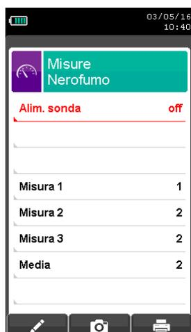
Misura del nerofumo tramite apposita sonda con testa riscaldata.
