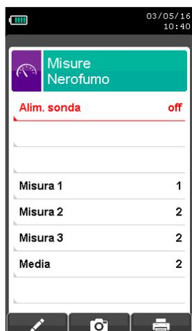
Utilizzando il kit pompa manuale, impostare su ' off ' l'alimentazione della sonda.
