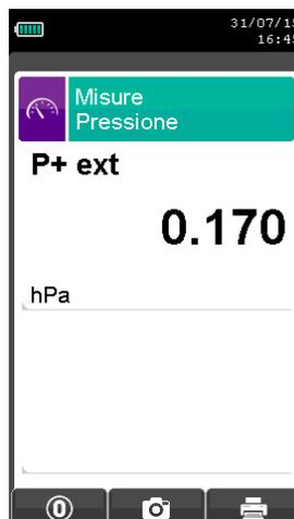
Misura della pressione mediante l'utilizzo del manometro deprimometro esterno.
